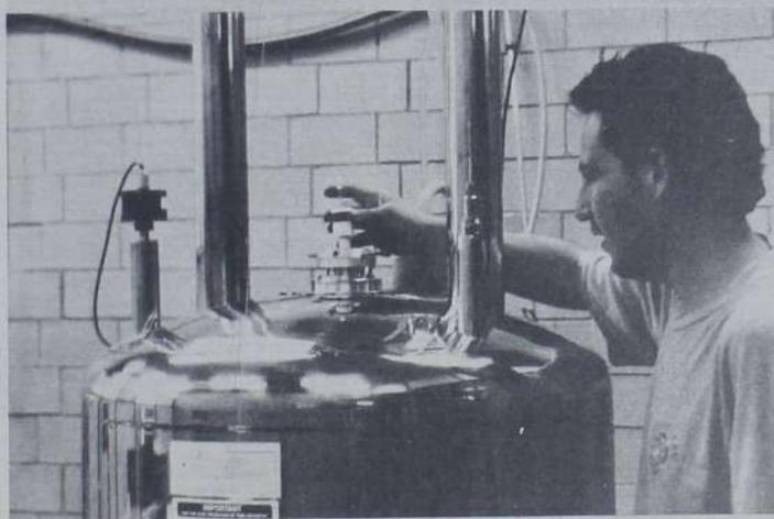
**Figura 4.** a) Un químico introduce una sustancia química al magneto de un instrumento de resonancia magnética nuclear en el que será analizada su estructura.
