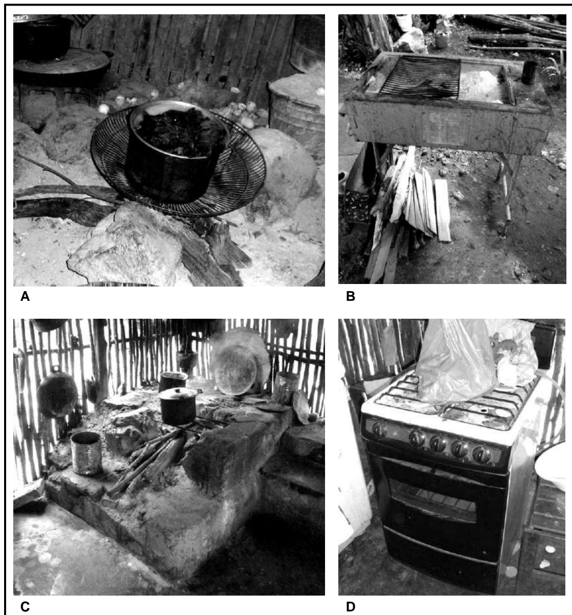
Figura 14. Dispositivos de cocción empleados por las participantes: A) FTP, B) EDL metálica, C) EDL de concreto y D) estufa de gas.
