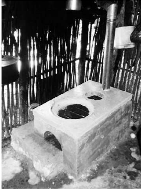
Estufa de dos entradas de leña recién construida
